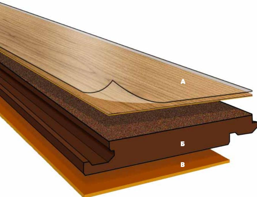
**A** Рабочая поверхность напольных панелей покрыта устойчивой к истиранию пленкой overlay, под которой располагается декоративный слой. Эти слои спрессовываются, создавая износостойкую, привлекательную и приятную на ощупь поверхность панелей.
