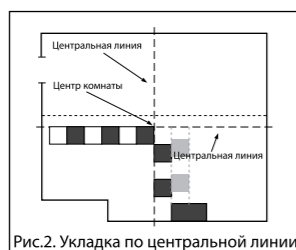
Рис.2. Укладка по центральной линии
